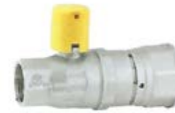
Valvola a sfera per colonna montante con attacco F/PE e tubo acciaio di protezione completo di boccola rinforzo tubo PE passaggio totale cappuccio sigillabile ottone e copricappuccio sigillabile
